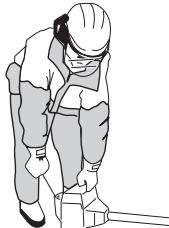
**TÄHELEPANU!** Ükski kehaosa ei tohi sattuda vastu märgistatud pinda. Kui süutekapsel on defektiga võib kontakti tulemuseks olla põletushaav nahal või elektrilöök. Kasuta alati kindaid. Ära kunagi kasuta masinat, mille süutekapsel on defektiga.
